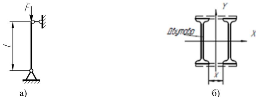
Рисунок 1. Схема закрепления стойки (а) и ее поперечное сечение (б).
